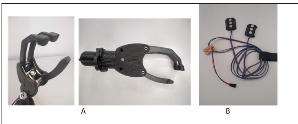
Legenda: A- Composição da prótese; B - Eletrodos.
